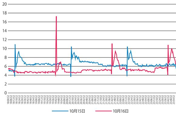
設置することにより、熱交換率が高まり、コンプレッサーの稼働時間が短くなるため、消費電力が低減します。
