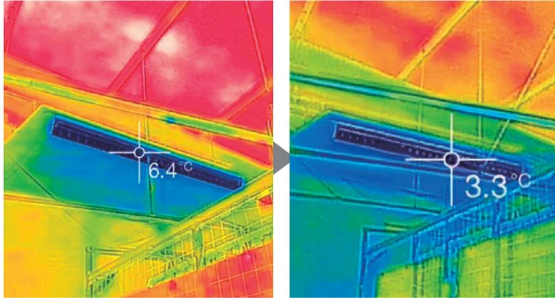
温度を解析するサーモ画像は、色が赤いほど温度が高く、青いほど低いことを意味します。「冷暖くん」設置前は、室内に赤の色が目立ちますが、設置後わずか1分程で周りの温度が劇的に下がったことがわかります。エアコンの吹出口の温度も約3°C温度が下がりました。「冷暖くん」を設置することにより、室内の温度むらがなくなり、全体にエアコンの熱が伝わりやすくなっています。
